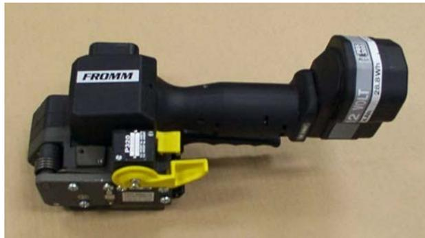
[Figure 1](#) - The Fromm Polystrapper
